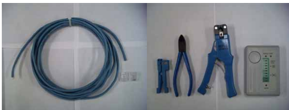
写真 2.1 LAN ケーブルの作成に必要な用具
