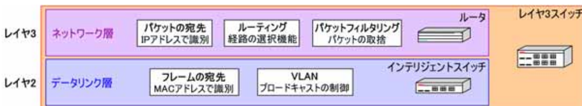
図 2.9 レイヤ3スイッチの機能 (R2.4 NETWORK MAGAZINEより)
